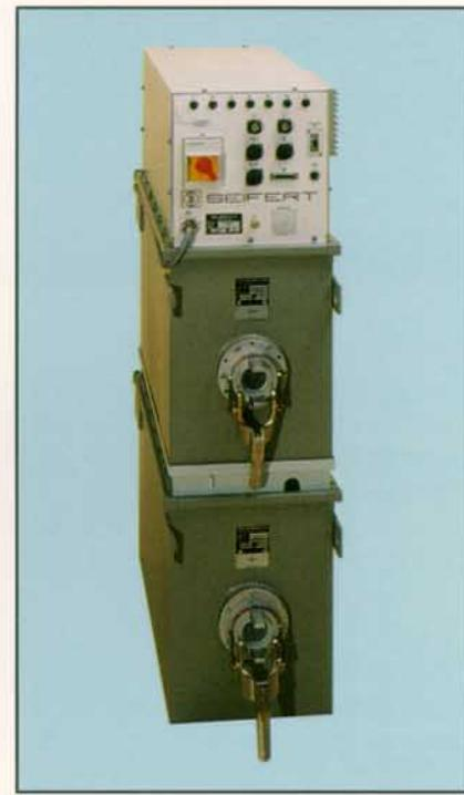
Die **Hochspannungsgeräte** sind mit Präzisionswiderständen zur Messung und Regelung der Röhrenspannung ausgerüstet. In der Hochspannungskaskade verwendete, hochwertige keramische Kondensatoren gewährleisten eine nahezu welligkeitsfreie Röhrenspannung (40 kHz, 6 V/mA).
